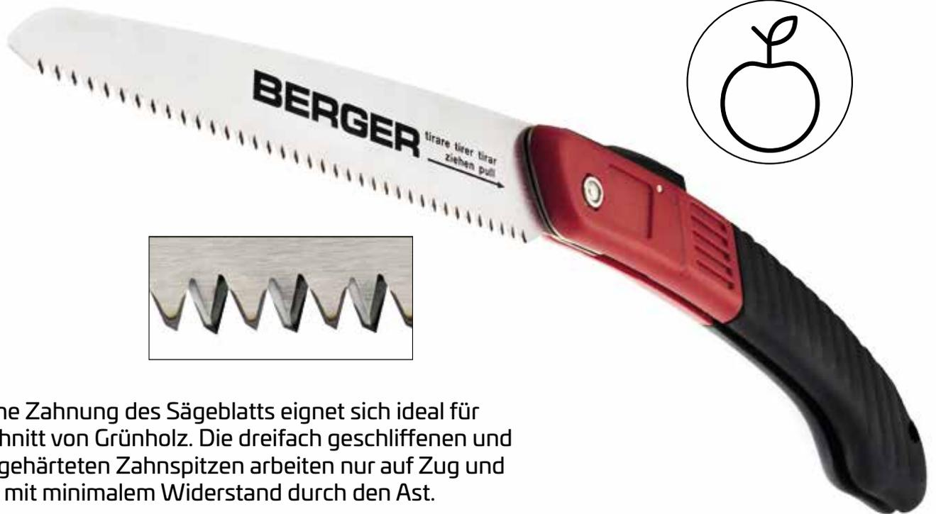
Die feine Zahnung des Sägeblatts eignet sich ideal für den Schnitt von Grünholz. Die dreifach geschliffenen und impulsgehärteten Zahnschneiden arbeiten nur auf Zug und gleiten mit minimalem Widerstand durch den Ast.
