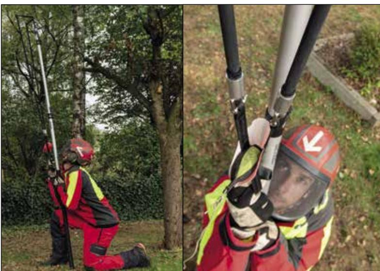
Der Rocket Master ist speziell für Baumpfleger konzipiert. Er lässt sich sekundenschnell auf jede ArboRapid-Teleskopstange klicken. So kann der mit einer Leine verbundene Wurfbeutel über Astgabeln auch in luftige Höhen geschleudert werden.
